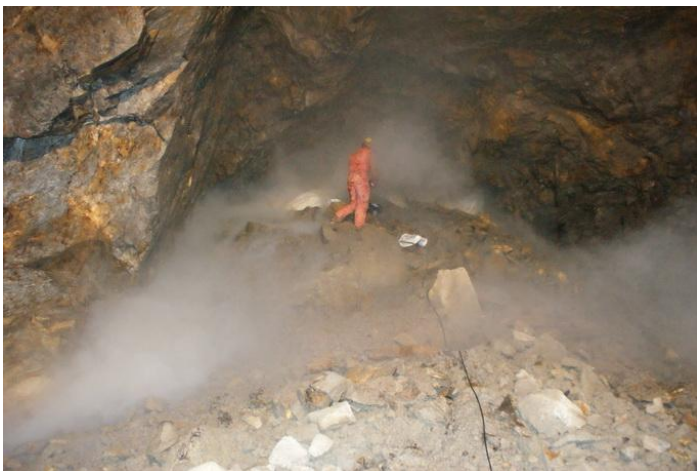
Zadymianie pustych przestrzeni nad korytarzem łączącym sztolnie numer II i III
